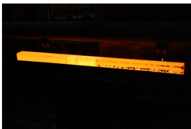
Knüppel mit untersuchten Beschichtungen (links: sonstige Beschichtung, mittig: Delta-Heat, rechts: ohne Beschichtung)
