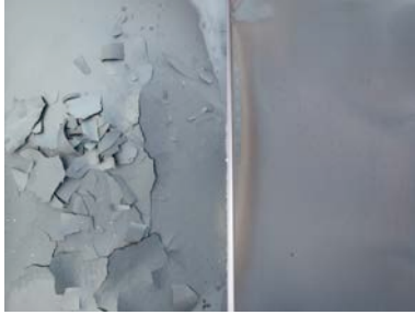
Probe (Q-Panel) linke Seite ohne Beschichtung, rechte Seite mit Delta-Heat beschichtet
